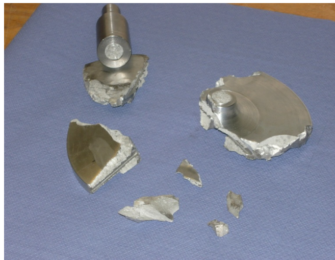
Rys 11 Fragmenty dysku z kanałami prostymi po badaniu niszczącym
