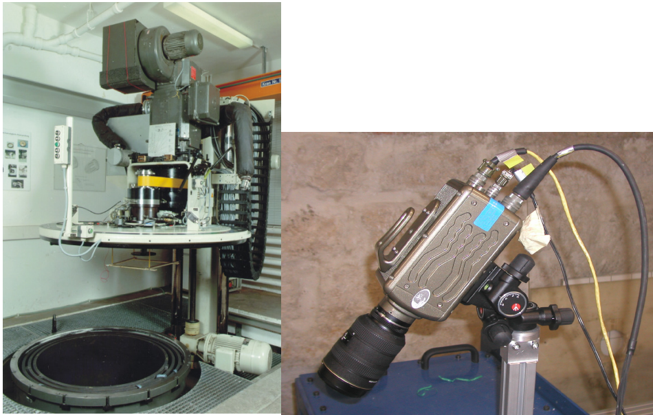
Rys. 8. Widok maszyny wytrzymałościowej oraz zastosowanej kamery szybkostrzelnej
