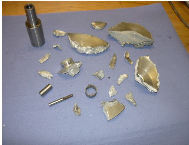
Rys 13 Fragmenty dysku z kanałami zakrzywionymi po badaniu niszcącym
