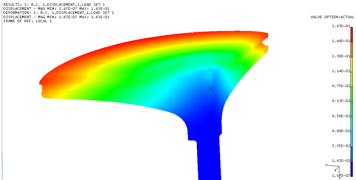
Rys. 6. Maksymalne przemieszczenia dla dysku z kanałami zakrzywionymi, prędkość 60 tys. obr/min
