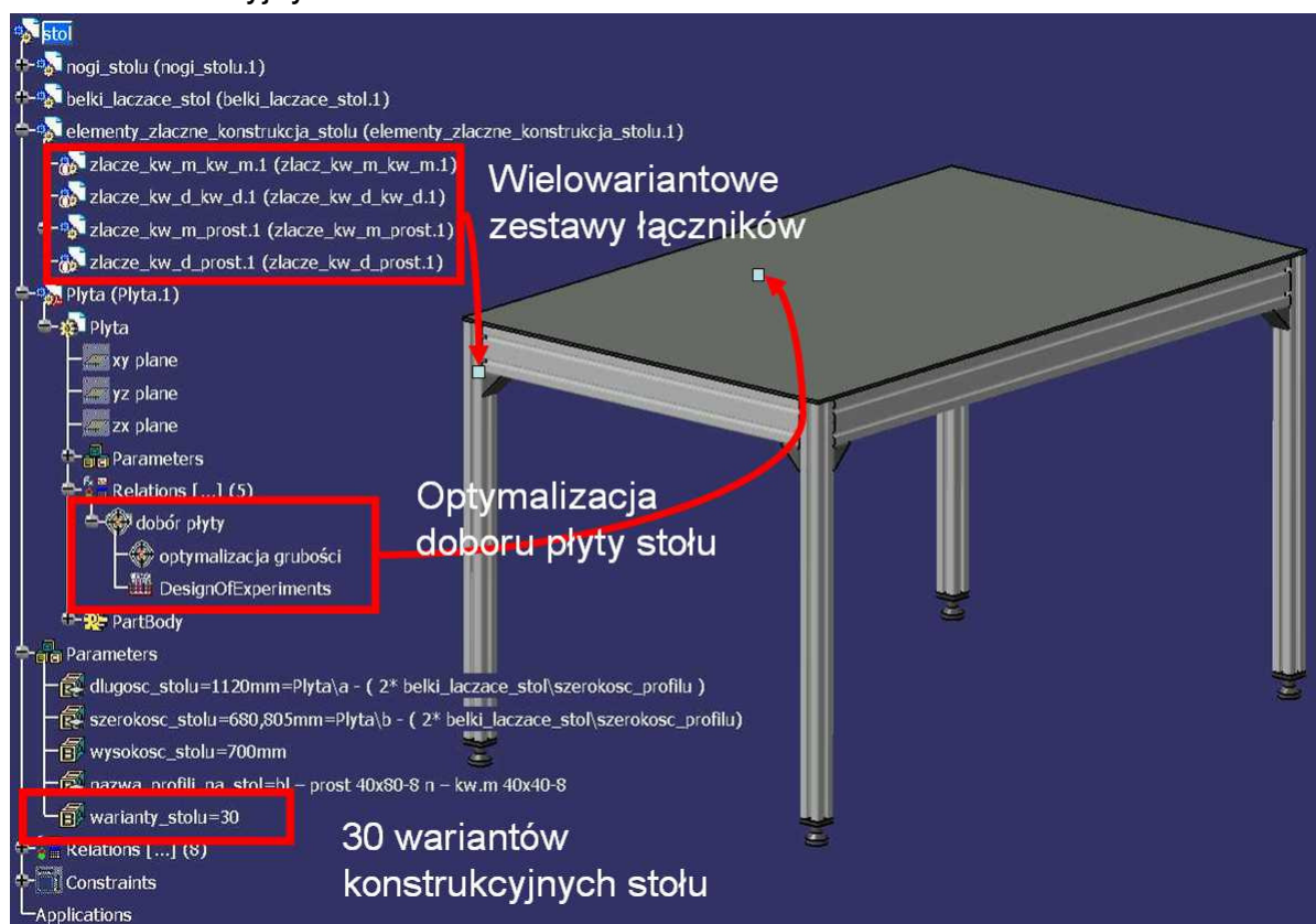
Rys. 6. Przykład integracji zadania optymalizacji blatu stołu roboczego
