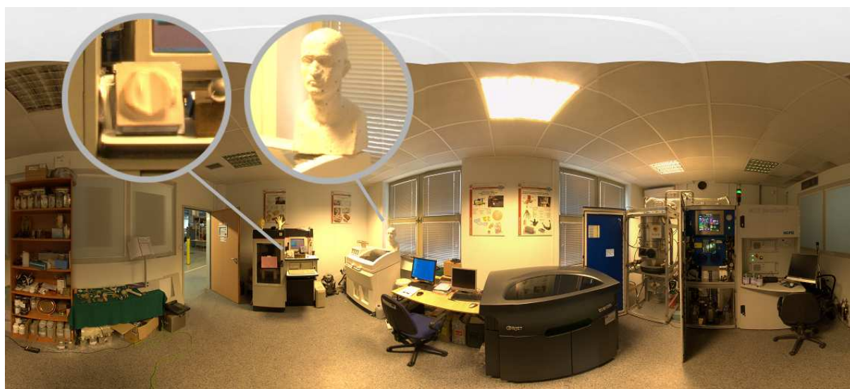
Rys. 1. Wynik digitalizacji pomieszczenia z zastosowaniem rejestracji koloru
