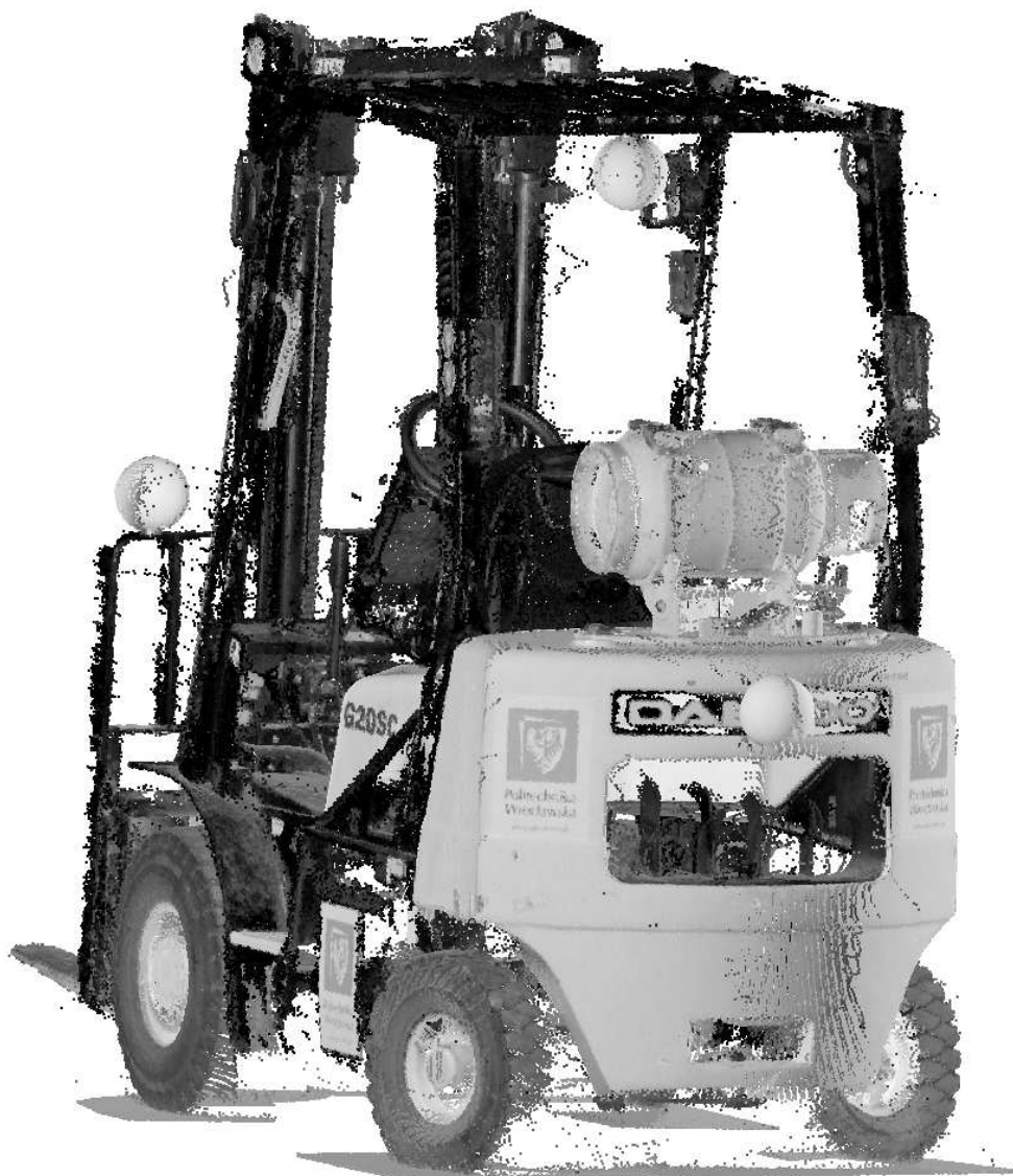
Rys. 2. Wynik digitalizacji wózka widłowego skanerem Faro Photon
