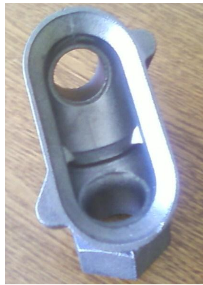
Rys.2. Przedstawienie rzeczywistego odlewu klasy korpus (EKO Wodrol Koszalin)
