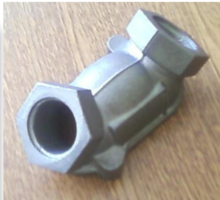
Rys.2. Przedstawienie rzeczywistego odlewu klasy korpus (EKO Wodrol Koszalin)
