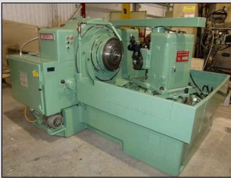
Obrabiarka Gleason 116 sterowana konwencjonalnie.
