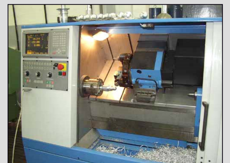
3-osiowa tokarka TPS200 firmy CBKO ze sterowaniem Meldas 500 firmy Mitsubishi. Posiada ona głowicę rewolwerową wyposażoną w narzędzia napędzane.
