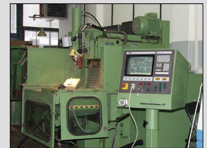
3-osiowa frezarka Avia FNF-40NA ze sterowaniem Pronum 640FC oraz ze sterowanym płynnie stołem obrotowym Jafo FNd250 (niewidoczny na zdjęciu).
