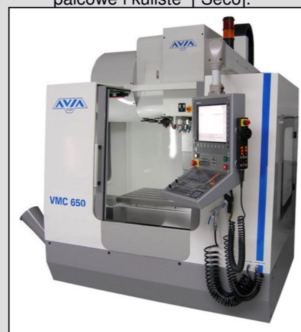
4-osiowe centrum frezarskie VMC-650 firmy Avia ze sterowaniem Heidenhain iTNC 530, do którego można podłączyć stół obrotowy Jafo FNd250 (niewidoczny na zdjęciu).
