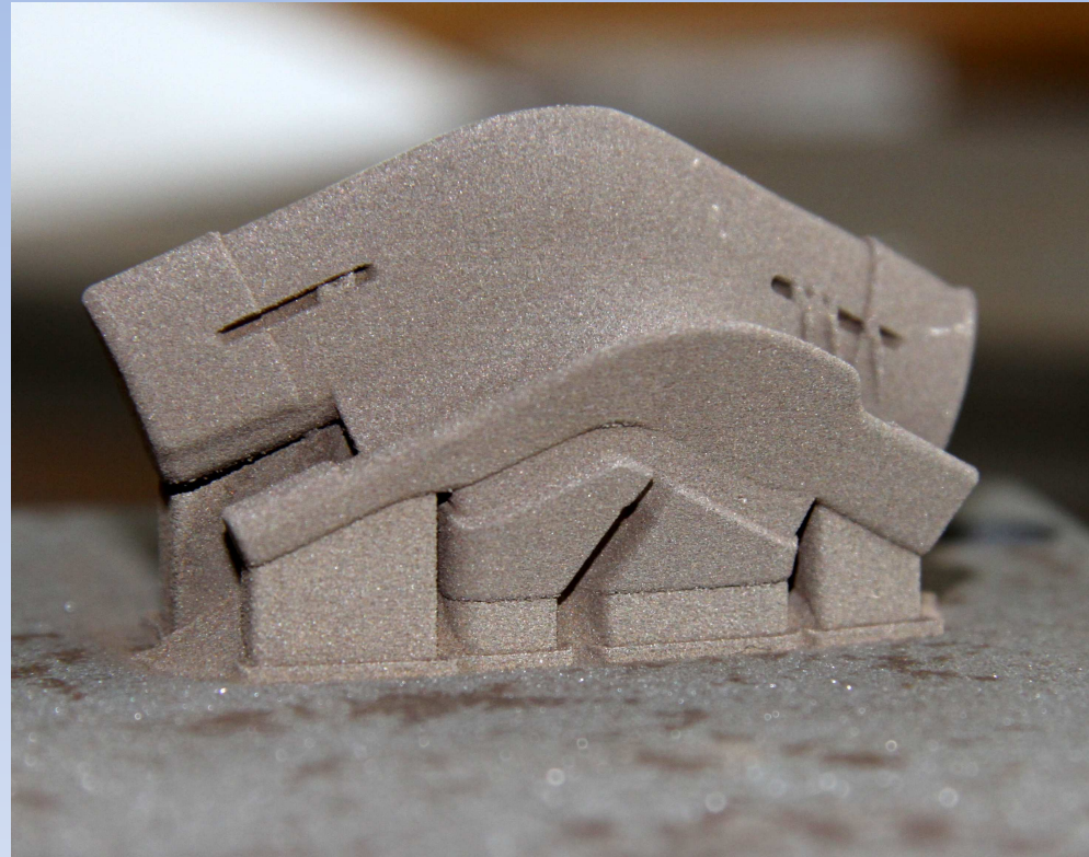
Władka formująca do uszczelki „A” spiekana na podporach, materiał: DirectMetal 20
