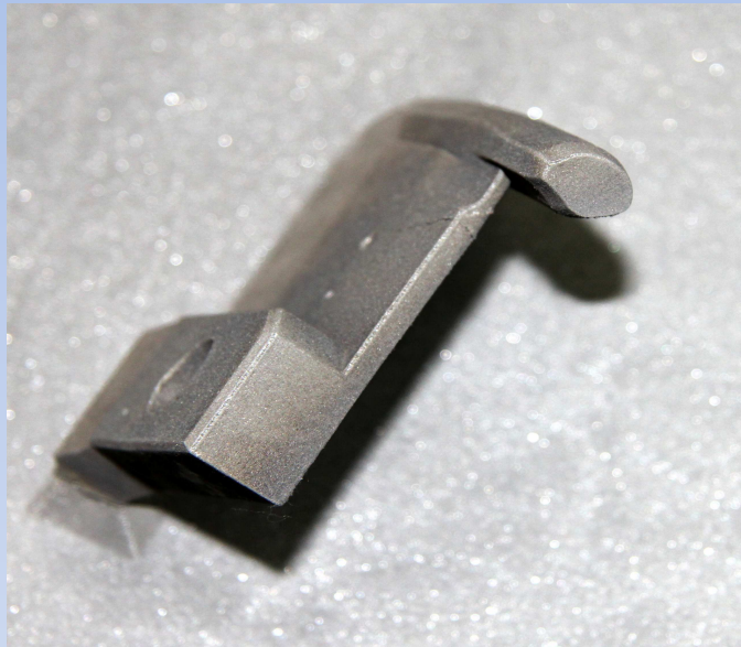
Wkładka formująca uszczelki „B” spiekana bez podpór w ułożeniu pochylonym. Materiał: DirectSteel H20
