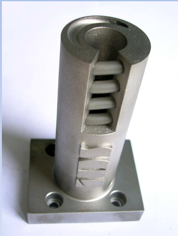
Element ze spiralnym kanałem chłodzenia wykonany z DirectSteel 20
