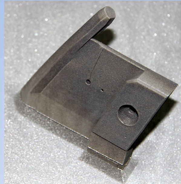
Wkładka formująca uszczelki „B” spiekana bez podpór w ułożeniu pochylonym. Materiał: DirectSteel H20
