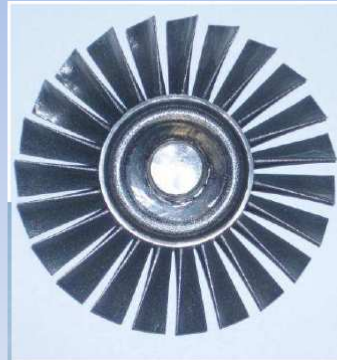
Element wykonany na EOSINT M270
