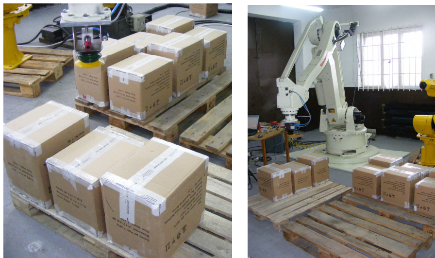
Rys. 1 Stanowisko do paletyzacji z robotem Kawasaki ZD130S
