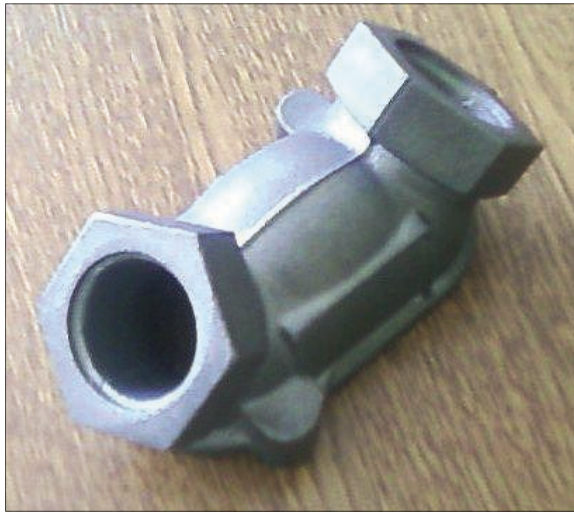
Rys. 1. Przedstawienie rzeczywistego odlewu klasy korpus (EKO Wodrol Koszalin)
