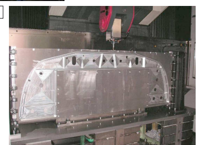
Przykład odkształconego detalu płaskiego po obróbce skrawaniem
