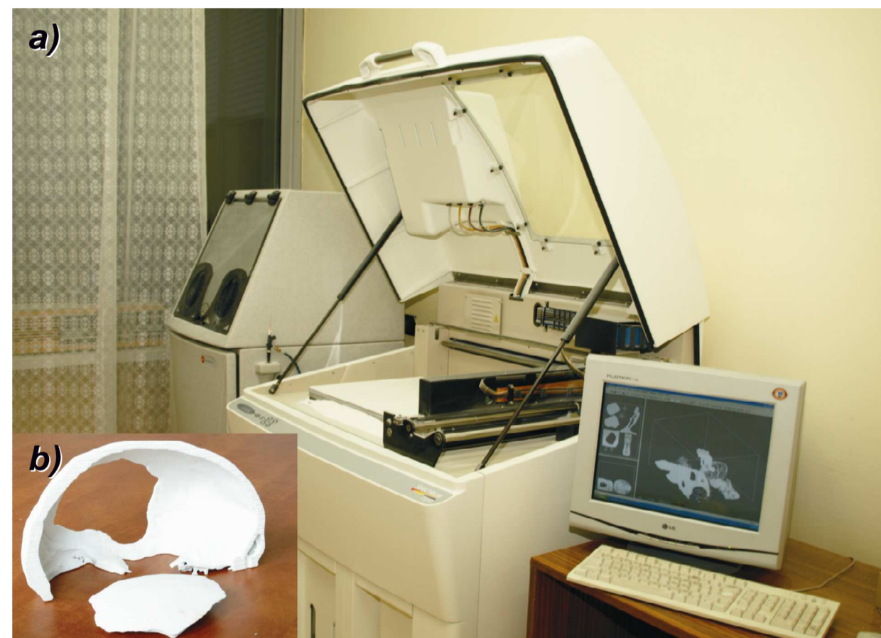
a) maszyna PolyJet EDEN 260 firmy OBJET w Katedrze Konstrukcji Maszyn PRZ; b) modele implantów ubytków czaszki; c) model fragmentu czaszki z ubytkiem
