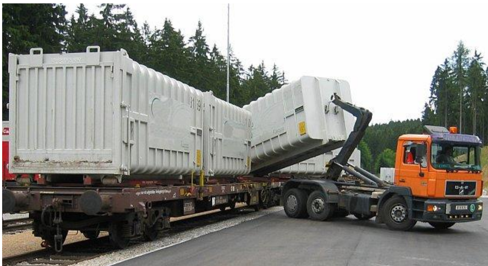
Rys. 1. Przykładowa platforma wagonu do przewozów intermodalnych w systemie ACTS
