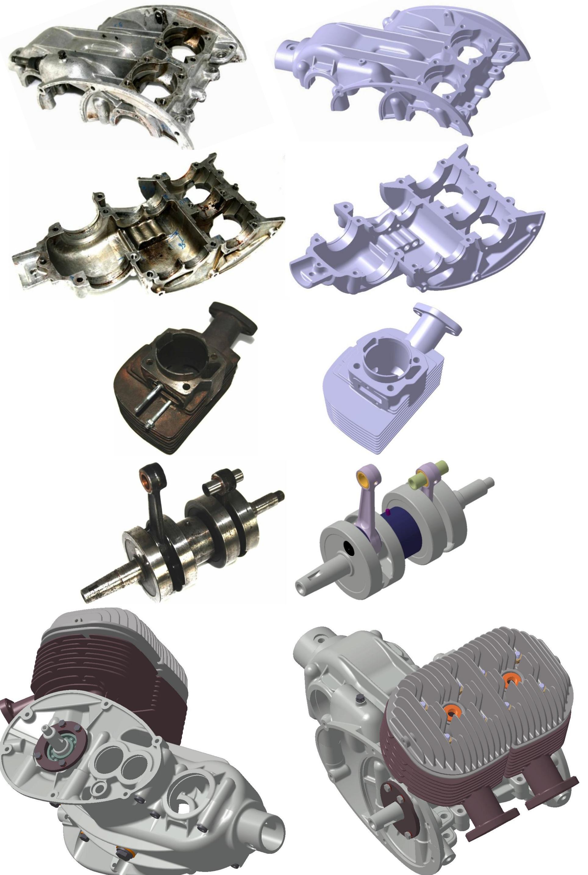
Wybrane elementy oraz model silnika w złożeniu. Optyczne różnice między fotografiami i modelami CAD wynikają z różnych odwzorowań (rzut środkowy i aksonometryczny)
