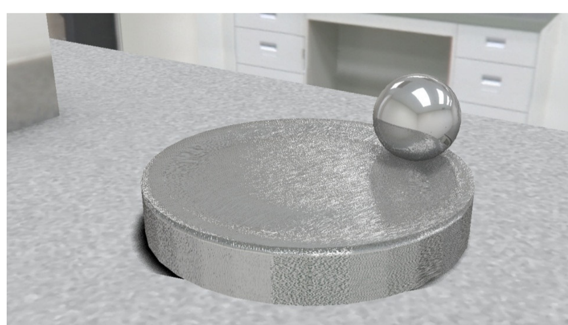
Rys. 5. Wyrenderowany obraz węzła tarcia kulka – tarcza testera T-01
