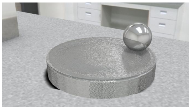
Rys. 4. Wyrenderowany obraz węzła tarcia kulka–tarcza testera T-01
