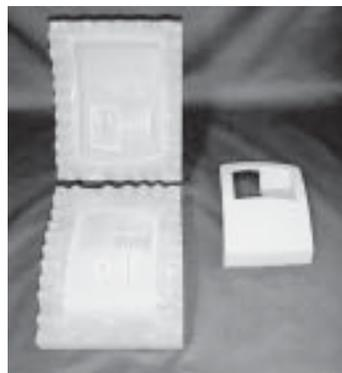
Rys.6. Wyroby wykonane w formach silikonowych.
