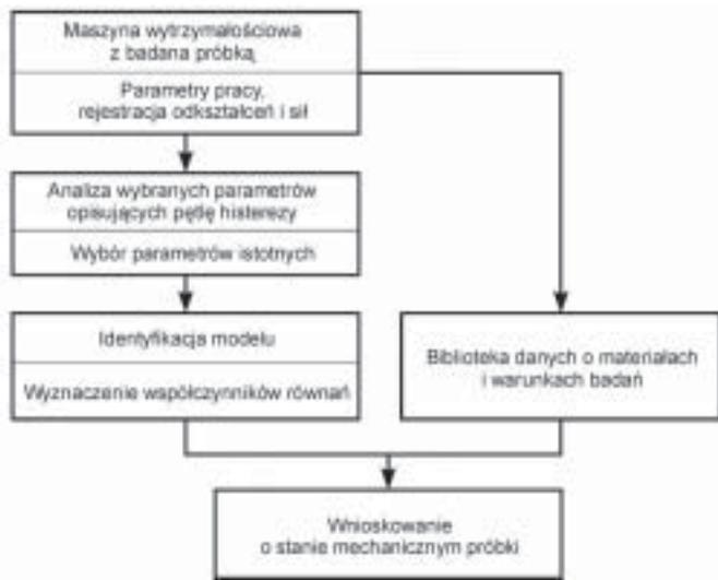
Rys. 3. Schemat określania stanu mechanicznego próbki.
