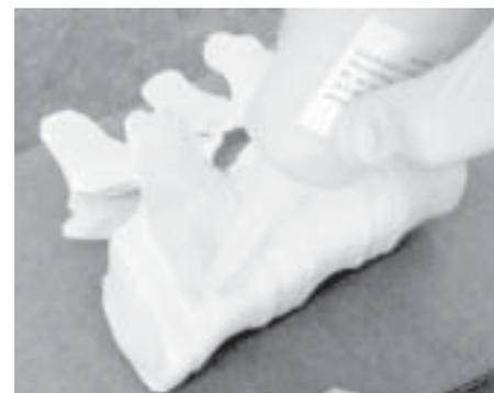
Rys.6. Utwardzanie powierzchniowe klejem cyjanoakrylowym.
