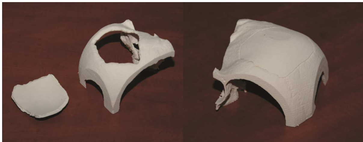
Rys. 7. Prototypy 3DP fragmentu czaszki z implantem.
