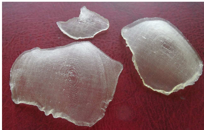
Rys.4. Prototypy implantów wykonane metodą stereolitografii.
