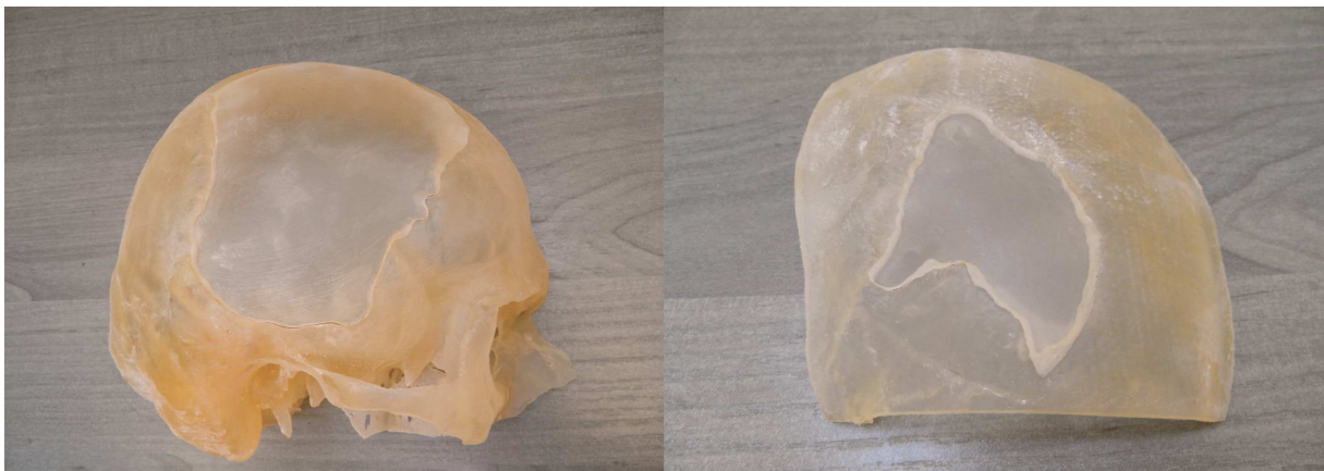
Rys. 5. Prototypy PolyJet fragmentów czaszek wraz z uzupełnieniami ubytków.
