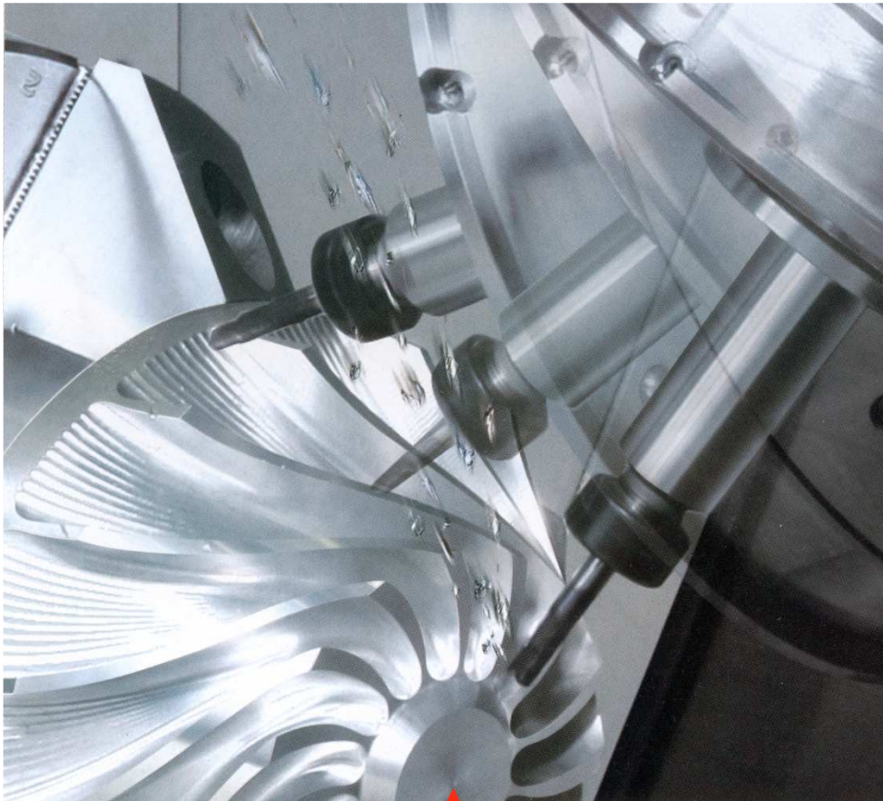
5-osiowe frezowanie integralnego wirnika ze stopu Al na centrum obróbkowym Integrex 200-IVST firmy Mazak
