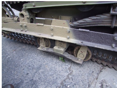
Rys. 2 TKS podczas Międzynarodowego Pikniku Lotniczego w Góraszce w 2009 roku (na prawej fotografii wyraźnie widoczny lewy wózek, który wyjechał z bieżni podczas próby skrętu)
