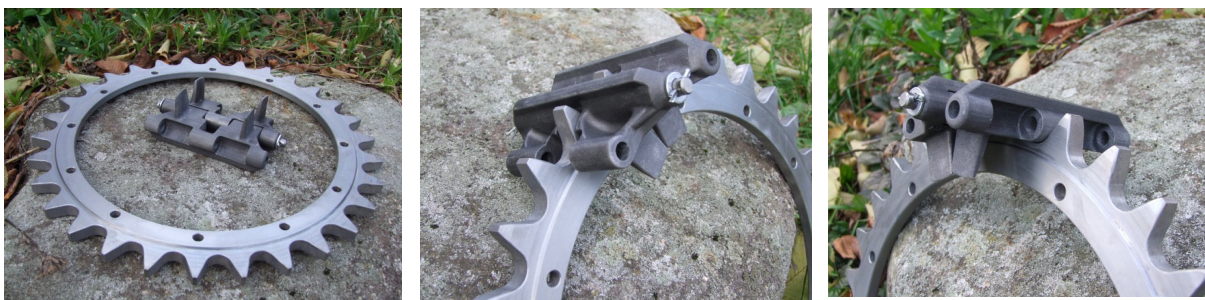
Rys. 10 Wydrukowane na drukarce 3D modele ogniwi oraz wyfrezowany na obrabiarce CNC wieńiec koła napędowego czołgu TKS
