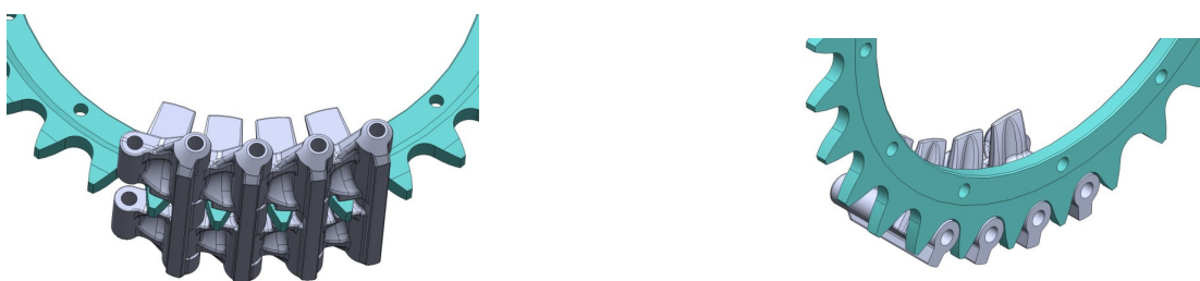
Rys. 7 wstępne pomiary na oryginalnym wieńcu koła napędowego czołgu TKS
