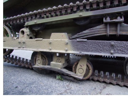
Rys. 2 TKS podczas Międzynarodowego Pikniku Lotniczego w Góraszce w 2009 roku (na prawej fotografii wyraźnie widoczny lewy wózek, który wyjechał z bieżni podczas próby skrętu)
