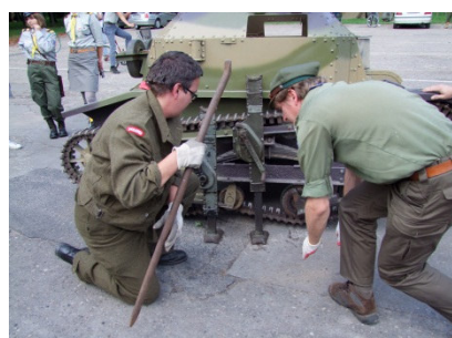
Rys. 3 operacja „lewarowania” w celu ustawienia wózka jezdzącego w bieżni gąsienicy
