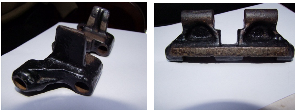
Rys. 4 Oryginalne ogniwo gaśienicy czołgu TKS – wyraźnie widoczne zużycie użytkowe (ubytki korozyjne oraz odkształcenia mechaniczne)
