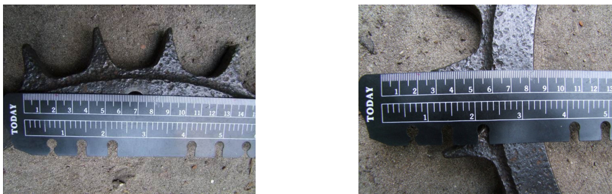
Rys. 7 wstępne pomiary na oryginalnym wieńcu koła napędowego czołgu TKS
