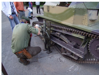
Rys. 3 operacja „lewarowania” w celu ustawienia wózka jezdzącego w bieżni gąsienicy
