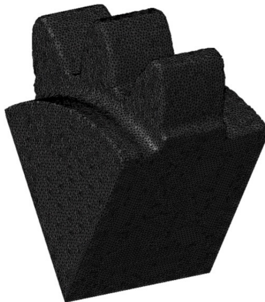
Rys. 10. Model dyskretny wycinka koła zębatego
