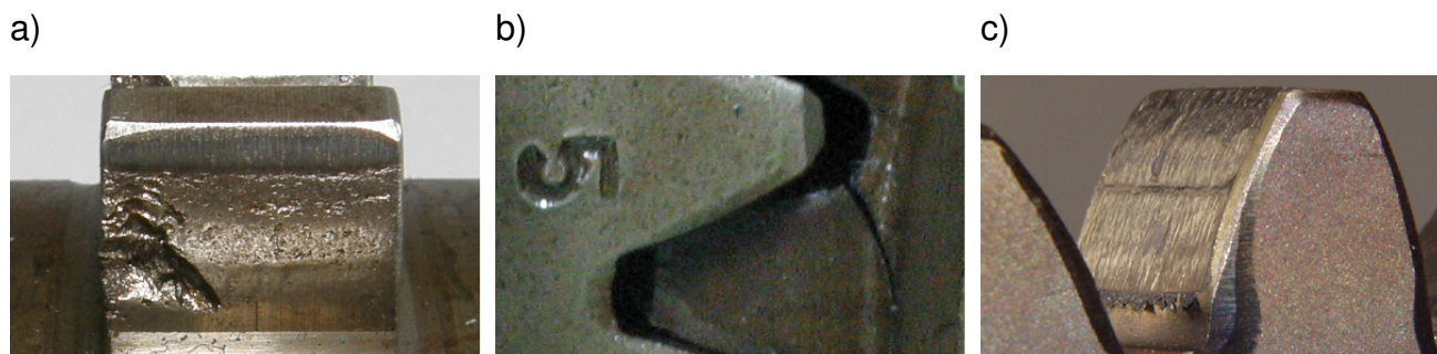
Rys. 1. Przykłady uszkodzeń zębów kół: a) pitting, b) pęknięcie zmęczeniowe, c) zatarcie
