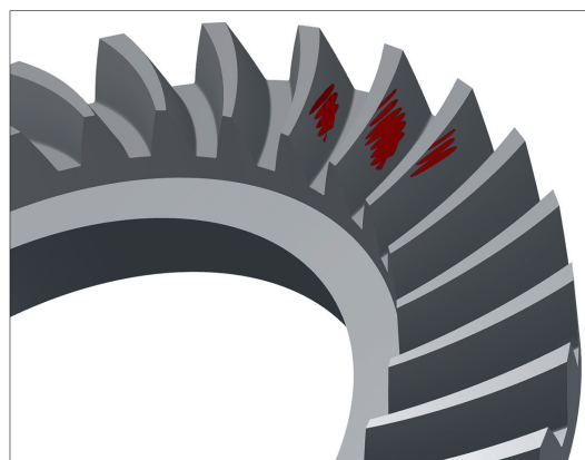
Rys. 2. Sumaryczny ślad styku na boku zęba koła
