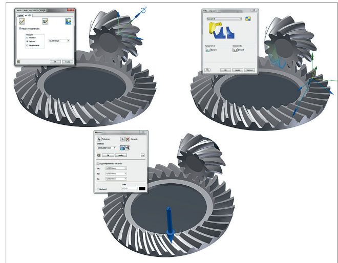
Rys. 5. Model przekładni stożkowej w środowisku symulacji dynamicznej
