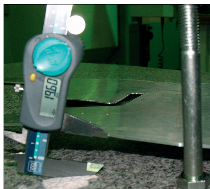
Rys. 8. Przykład ugięcia detalu płaskiego po obróbce skrawaniem
