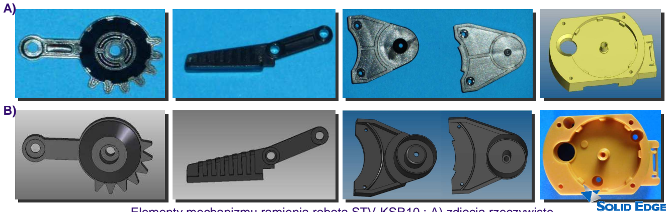
Elementy mechanizmu ramienia robota STV-KSR10 : A) zdjęcia rzeczywiste, B) modele wirtualne stworzone w programie Solid Edge
