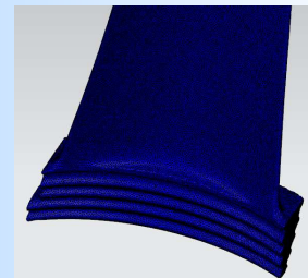
Model triangulacyjny uzyskany ze skanera oraz zoptymalizowana siatka w systemie CATIA
