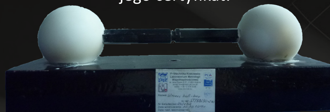
Wzorzec typu ball-bar oraz jego certyfikat:
