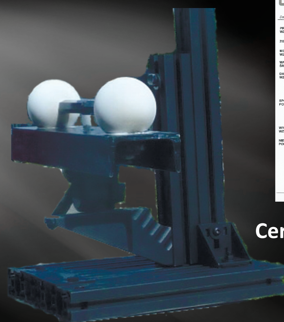
Wzorzec typu ball-bar oraz jego certyfikat:
