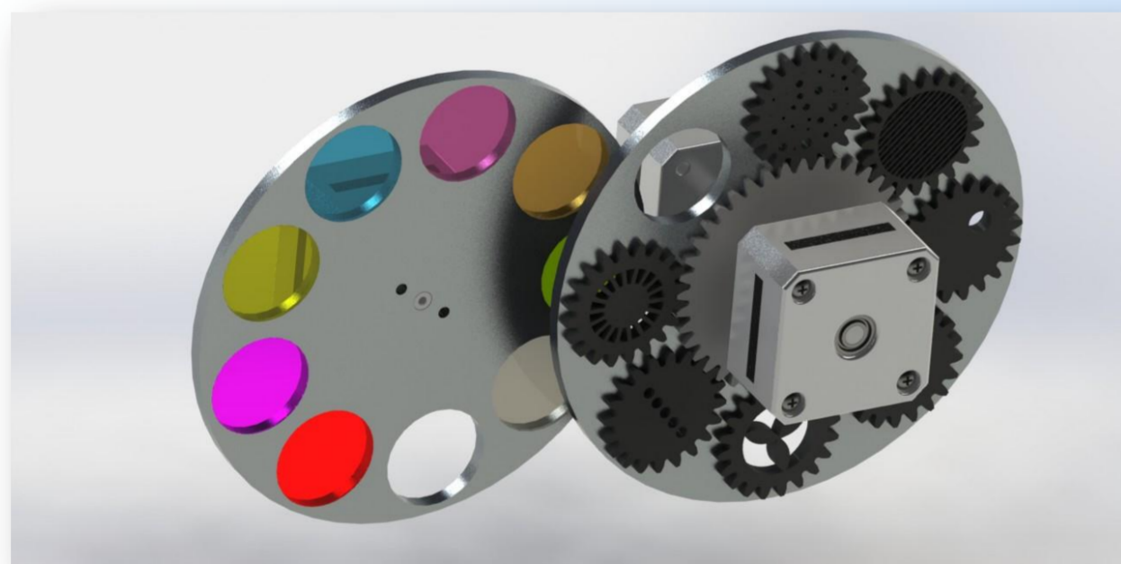
Tarcze kolorów i gobo wraz z silnikami krokowymi
