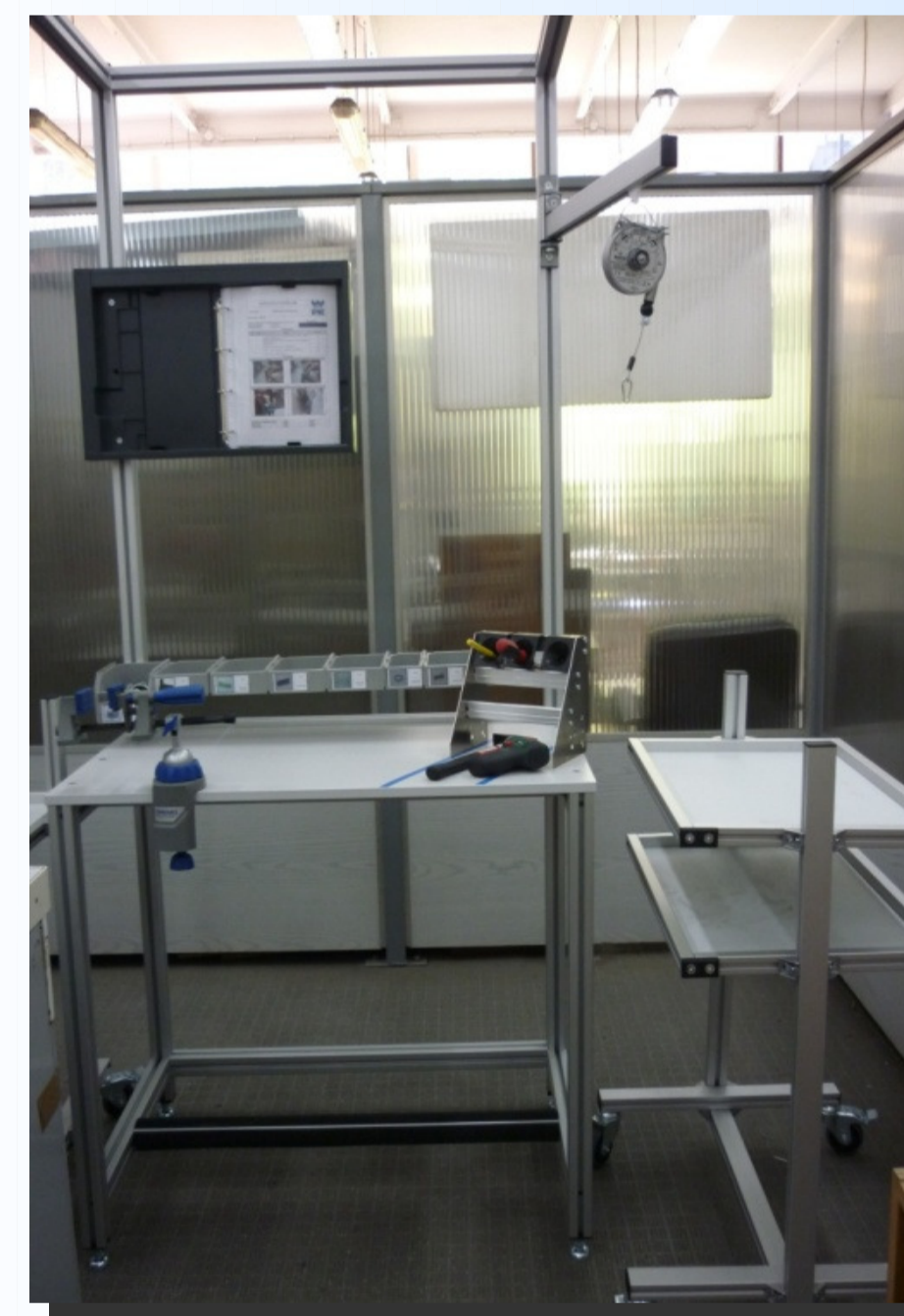
Stanowisko ST2 - montaż zespołu korpusu dolnego i montaż gotowych zespołów
