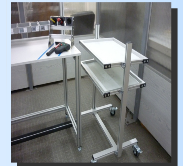
W2 - wózek odkładczy na gotowe wyroby
