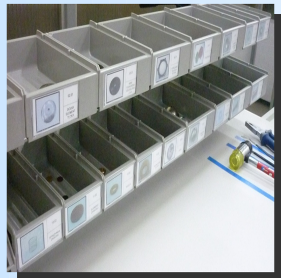
Pojemniki na poszczególne części pompy. Pojemniki opisane wg zasady 5S
