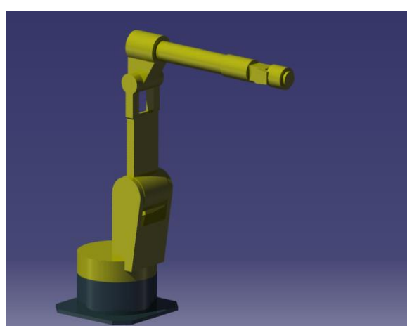
Rys. 3. a) Części manipulatora, b) złożenie wykonane w środowisku CATIA
