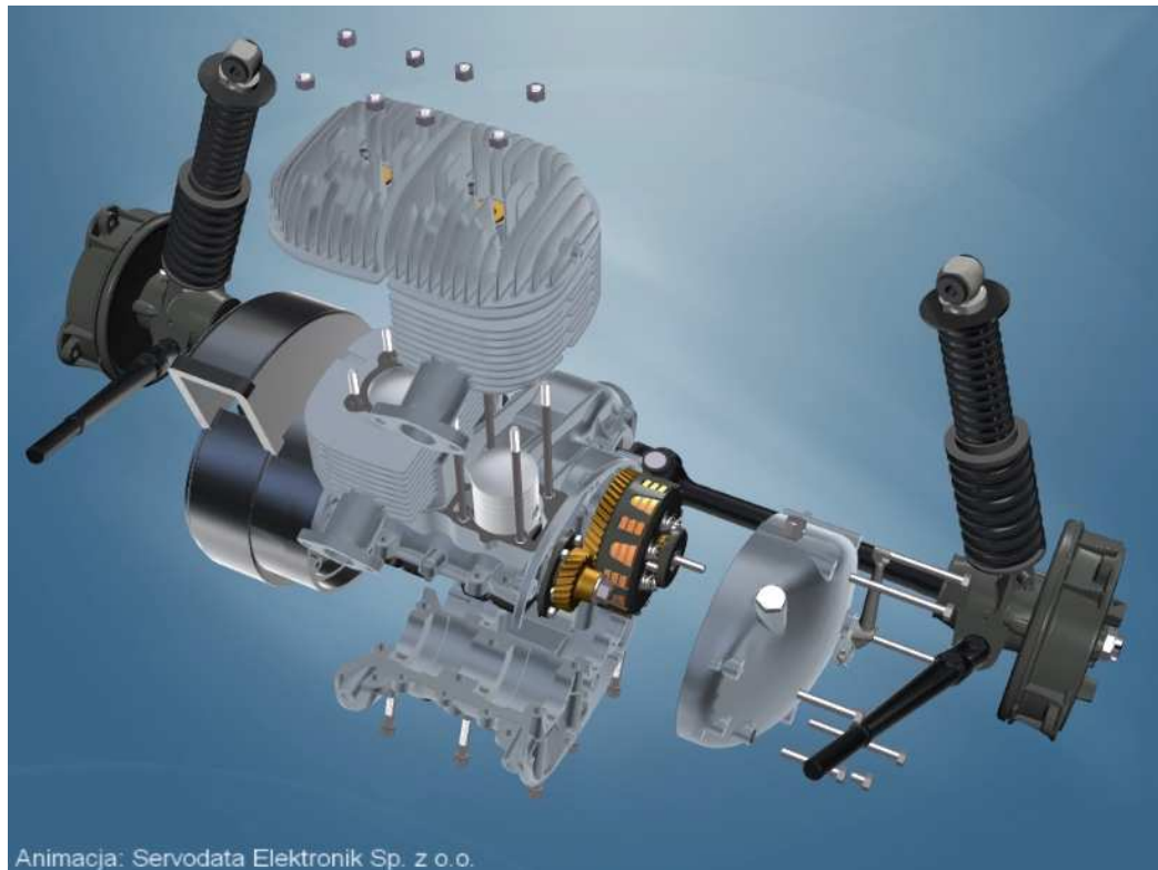
Rys. 5.4 Model układu napędowego Mikrusa w częściowym rozłożeniu
