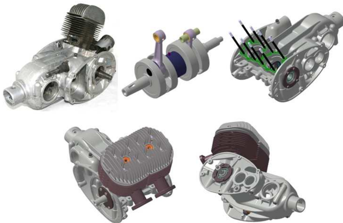
Rys. 2.6 Wykonanie złożenia. U góry po lewej fizyczny egzemplarz silnika, wykorzystany do pomiarów
