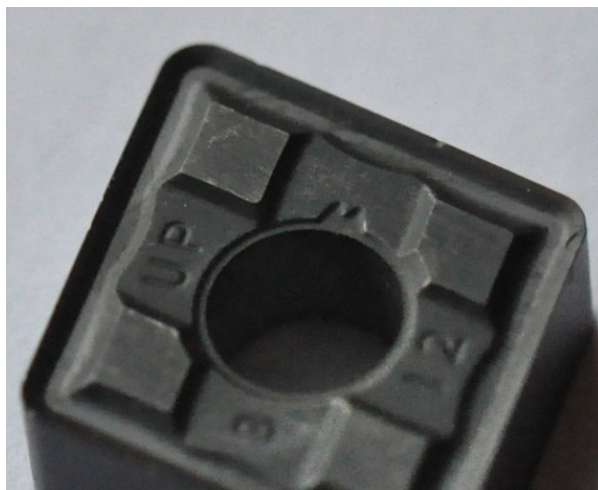
Rys. 1. Geometria rzeczywistej wkładki ostrzowej
