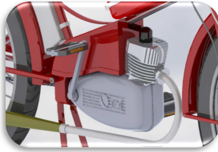
Rys. 4. Model 3D ukazujący budowę układu napędowego motoroweru
