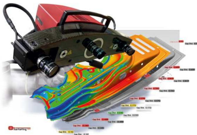
Rys. 7. Zastosowanie skanera przestrzennego umożliwia przeprowadzenie analizy mapy odchyłek względem rzeczywistego obiektu a zaprojektowanym modelem wirtualnym [6] http://www.e-skanowanie3d.pl/
