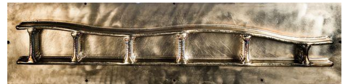
Wymiary części 1200x6201x349mm, tytan, BAESYSTEMS
