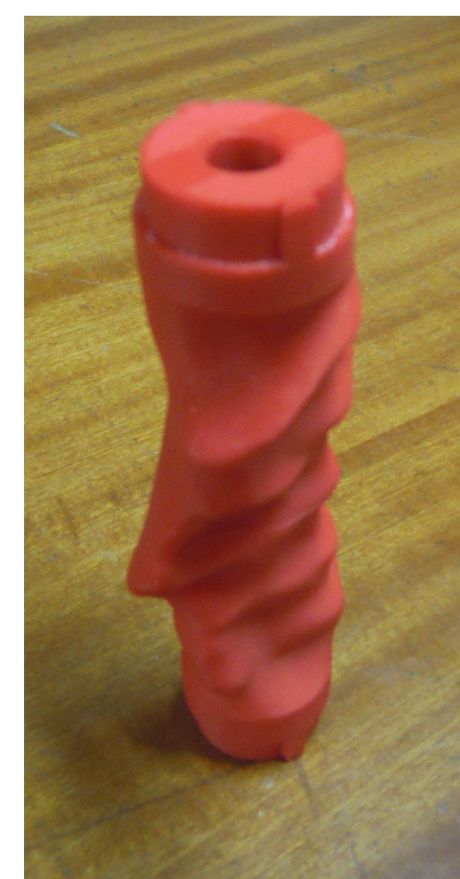
Uchwyt wykonany technikami szybkiego prototypowania metodą FDM
