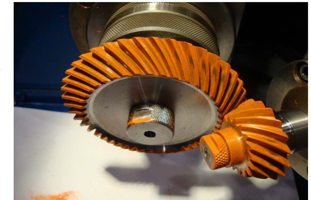
Rys. 8 Ślad współpracy pary stożkowej uzyskany na kontrolerce (bez obciążenia)
