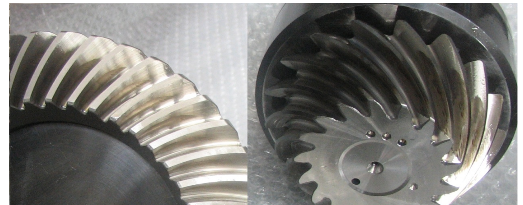
Rys. 9 Ślad współpracy uzyskany pod obciążeniem na maszynie wytrzymałościowej TS30, uwidoczny na kole i na zębiku
