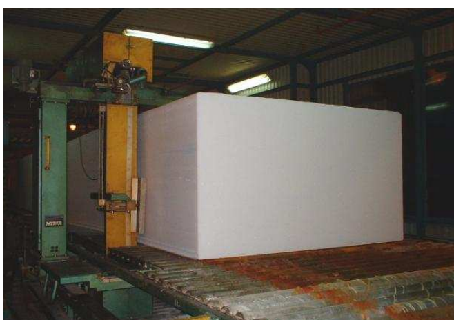
Rys. 2 Blok pianki poliuretanowej wychodzący z tunelu produkcyjnego [5]
