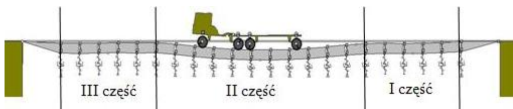
Rys.2. Widok deformacji kompletnej wstęgi z rozróżnieniem stref analizy
