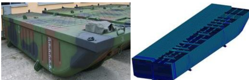
Rys.3. Widok rzeczywistego pontonu wstęgi PP-64 i modelu numerycznego 3D z przekrojem cząstkowym
