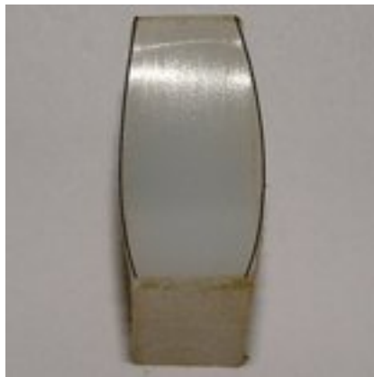
Rys. 9. Klocek z UHMWPE po badaniach tribologicznych z zaznaczonymi odkształconymi krawędziami bocznymi
