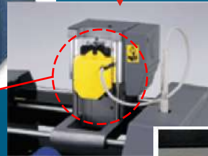
Głowica skanująca zamontowana na frezarce
