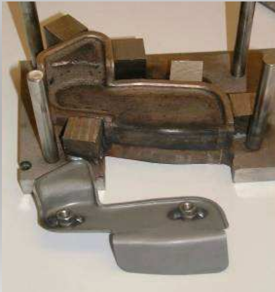
Zawias drzwi wykonany z 2.5 mm blachy stalowej; matryca z DirectMetal 20
