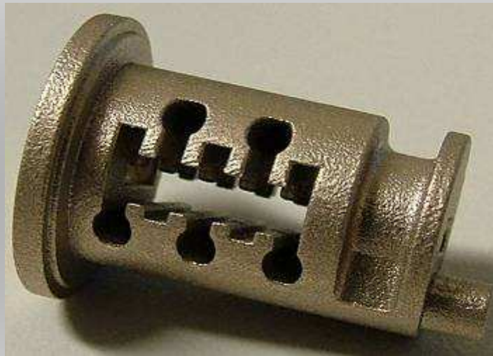
Wkładka zamka wykonana z DirectMetal 20, pojedynczy proces DMLS zastępuje 16 operacji EDM.
