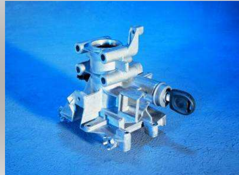
Obudowa blokady kierownicy wykonana z magnezu w formie z DirectMetal 20
