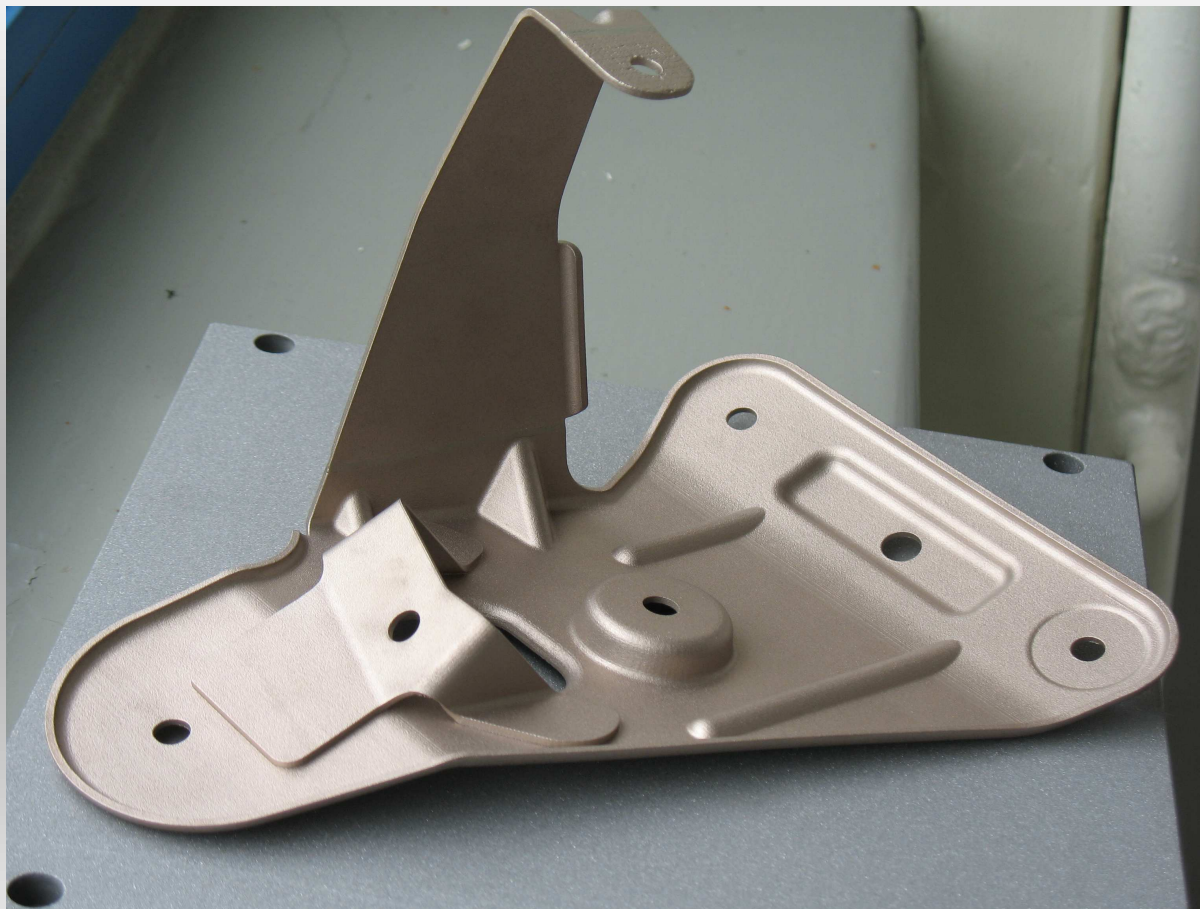
Element z DirectMetal 20 spiekany w częściach i następnie spawany laserowo
