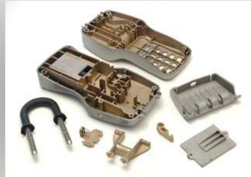
8 części złożeniowych kłódki w DirectMetal 20, czas dostawy 1 tydzień (80% redukcja czasu)
