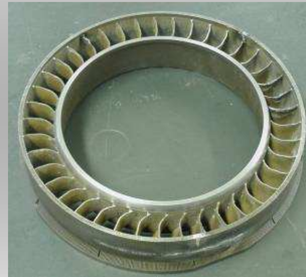
Prototypowa obręć statora helikoptera z DirectSteel 20
