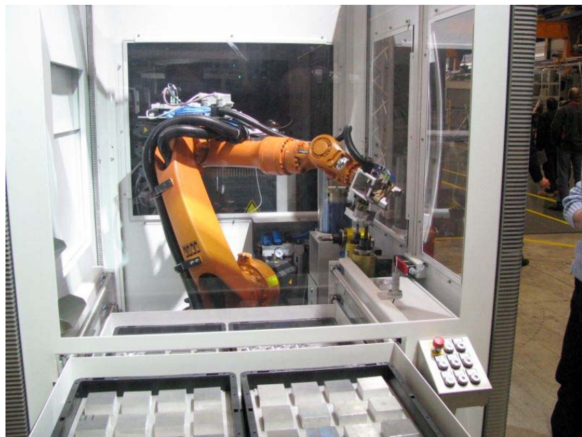
Obsługa Frezarki CNC przez robota. Paleta zawiera 32 detale
