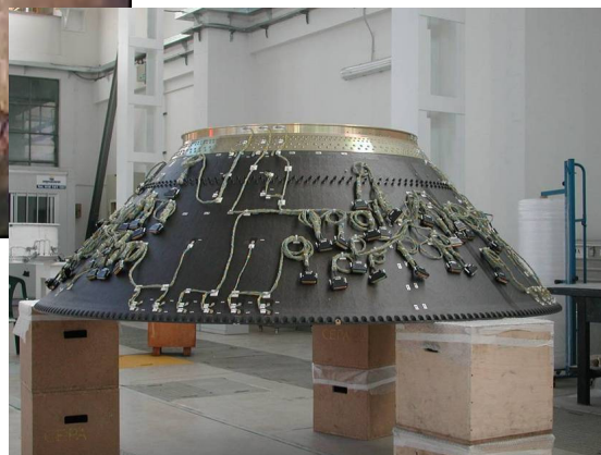
Pomiar naprężeń w elementach konstrukcji statku ARIANE 5
